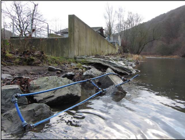
Abb. 16: Bei Hochwasser verschobene „schwimm drüber“-Antenne 1 am Auer Kotten
