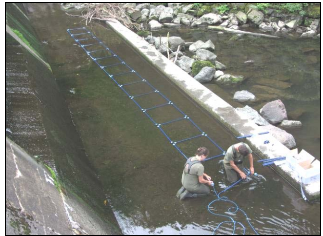
Abb. 10: Montage der „schwimm drüber“-Antenne in Strickleiterbauweise für das Mutterbett
