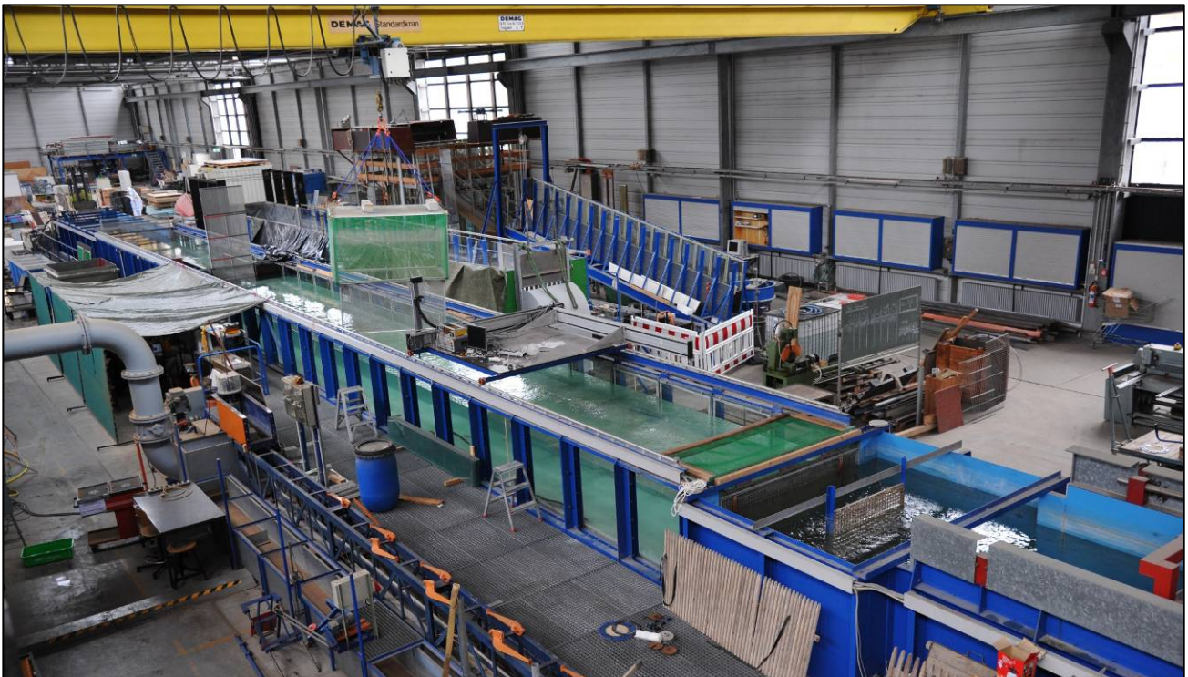
Abb. 51: In der großskaligen ethohydraulischen Laborrinne der TU Darmstadt wurden im Rahmen des FuE-Projekts Verhaltensbeobachtungen mit Fischen zur Erarbeitung von Anforderungen an Bypässe durchgeführt
