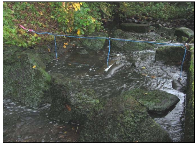
Abb. 7: HDX-Antenne 24 im mittleren Abschnitt der gelenzten Fischaufstiegsanlage
