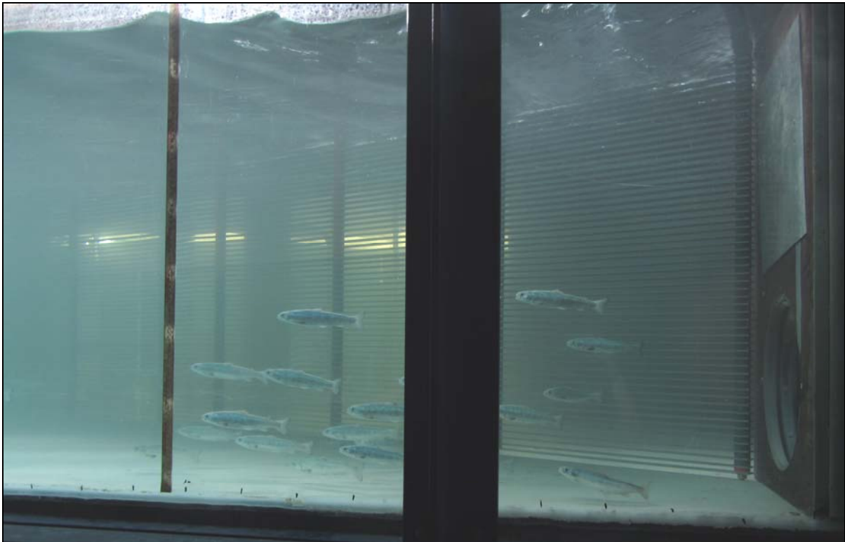
Abb. 63: Konzentration von Lachssmolts vor dem Bypass am abstromigen Ende eines Schrägrechens im ethohydraulischen Test
