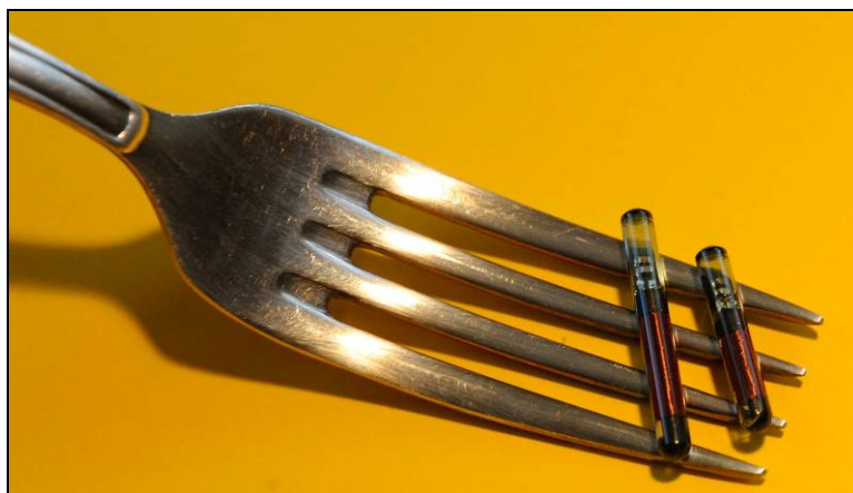
Abb. 1: Größenvergleich eines 23 mm und eines 32 mm langen, jeweils 3,9 mm dicken HDX-Transponders
