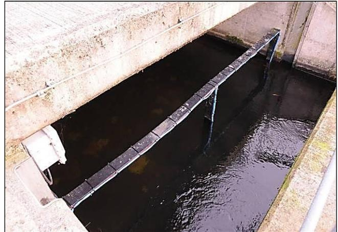
Abb. 42: Rahmenantenne am oberwasserseitigen Ausstieg (Foto: Institut für angewandte Ökologie)
