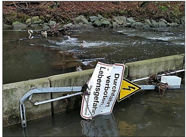
Abb. 13: Durch Hochwasser und Treibgut zerstörte Rahmenantenne und Tunerbox (Fotos: Institut für angewandte Ökologie)
