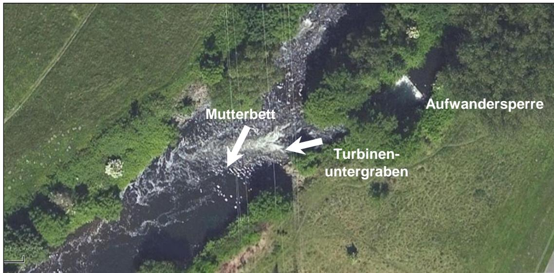
Abb. 18: Aufwändersperre am Zusammenfluss von Mutterbett und Turbinenuntergraben des Wasserkraftstandortes Reuschenberger Mühle (Quelle: Google Earth)
