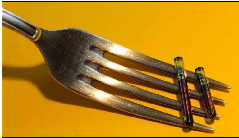
Abb. 1: 23 mm und 32 mm lange HDX-Transponder haben einen Durchmesser von 3,9 mm und wiegen pro Stück weniger als 1 Gramm
