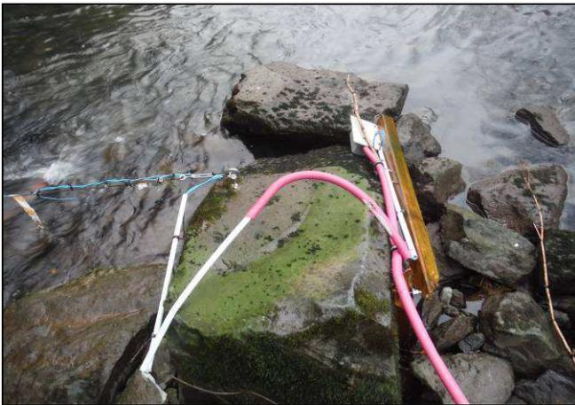
Abb. 31: Durch Treibgut abgeknickter Holzständer mit Tunerbox
