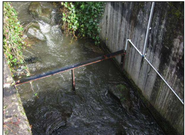
Abb. 21: Obere Rahmenantenne Nr. 42 nahe dem Ausstieg
