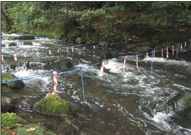
Abb. 17: Kabelantennen 32 und 33 im Raugerinne-Beckenpass
