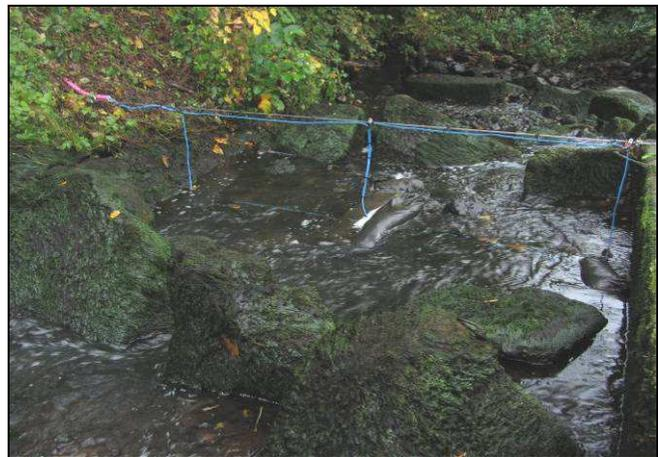
Abb. 15: HDX-Kabelantenne 24 im mittleren Abschnitt bei gelenzter Fischaufstiegsanlage
