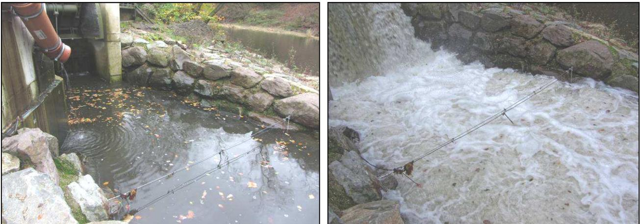
Abb. 28: Ursprünglich im Leerschuss des Auer Kotten installierte Kabelantenne Nr. 5, links bei geschlossener und rechts bei geöffneter Schwallklappe
