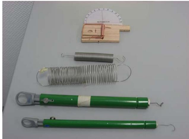
Dadurch wird die Proportionalität von Auslenkung und benötigter Kraft in allen drei Fällen (auch bei der Mausefalle) deutlich. Bei der Präparation der Mausefalle empfiehlt es sich, in die Bodenplatte der Mausefalle ein Loch zu sägen, um Platz für den Kraftmesser zu schaffen.
