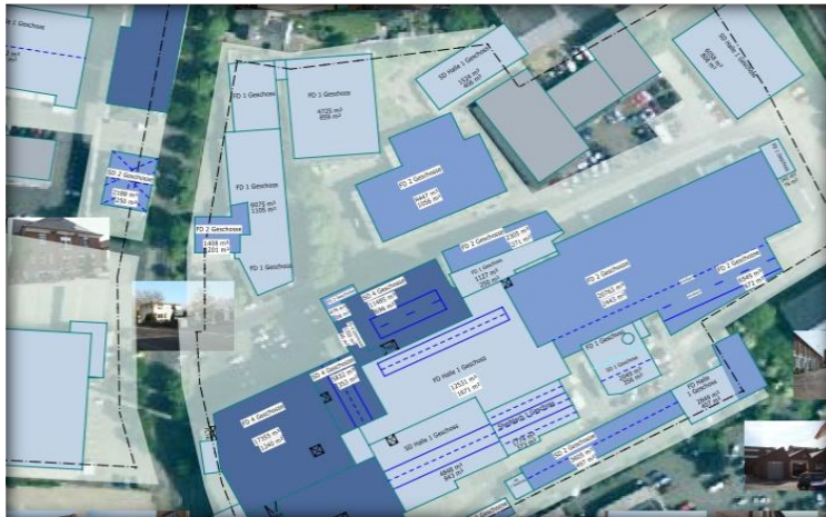
Planungskonzept zur Umnutzung eines Betriebsgeländes
